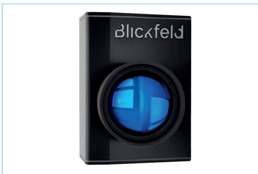
Bild 17. Von Blickfeld gibt es mit der Bezeichnung Cube Range einen Lidar-Sensor, der Hindernisse in bis zu 250 Metern Entfernung erkennt. Der 3D-Solid-State-Lidar verfügt über eine Reichweite von 150 Metern bei 10 Prozent Reflektivität; eine Reichweite von bis zu 250 Metern ist bei höherer Reflektivität möglich; die Auflösung beträgt 0,18°. Das Produkt nutzt einen MEMS-Spiegel aus Silizium. Die dichte 3D-Punktwolke wird per Software-Stack in Echtzeit verarbeitet. Der Sensor ist für Fahrten mit Autobahntempo geeignet. (Bild: Pressebild Blickfeld GmbH)
